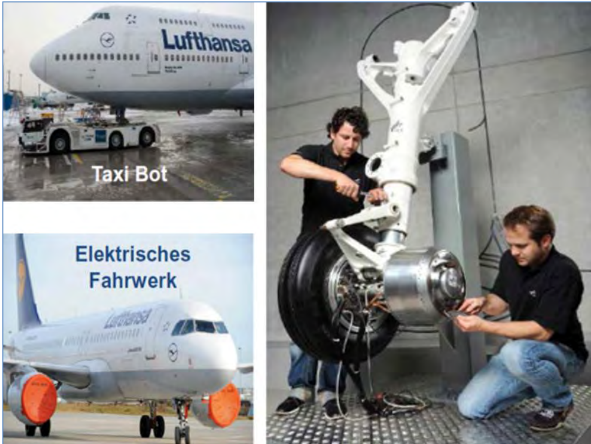
Abbildung 24: Alternative Antriebskonzepte bei Rollvorgängen zur Vermeidung von Bodenlärm [1]
